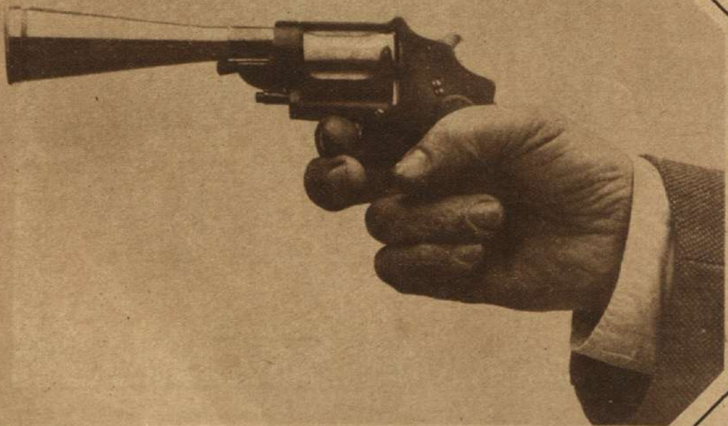
UN INGENIOSO INVENTOR francés, el profesor Diou, ha inventado un sencillo aparato adaptable a cualquier arma de fuego, para disparar cartuchos cargados de gases que derriban al atacado durante diez minutos, y al recobrar el sentido permanece diez minutos más completamente ciego.
