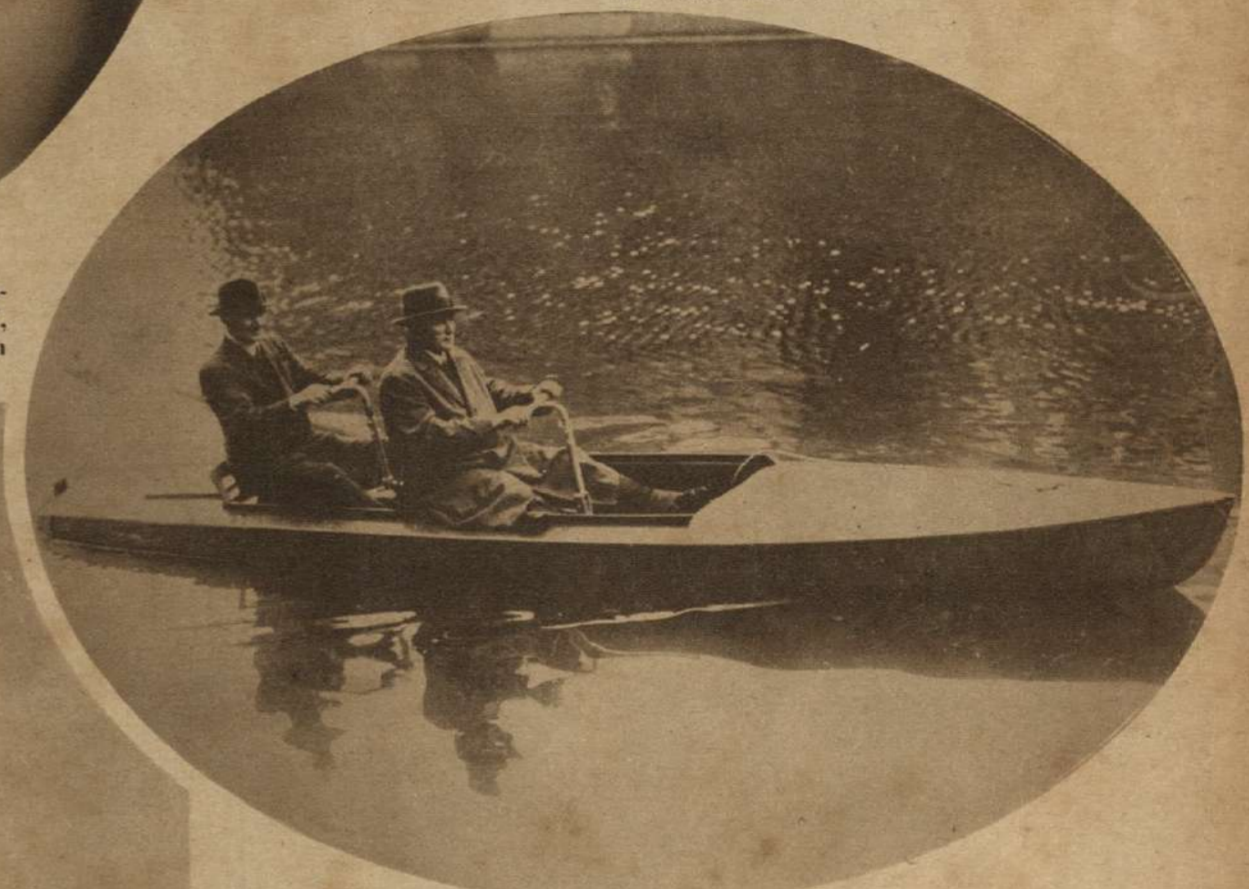
Nuevo sistema de propulsión: Este bote se mueve por medio de palancas que hacen funcionar la hélice, por cuyo procedimiento se imprime al barco una velocidad de 10 km. por hora.
