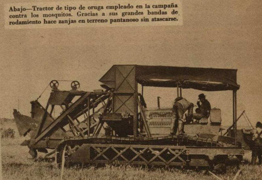
Abajo—Tractor de tipo de oruga empleado en la campaña contra los mosquitos. Gracias a sus grandes bandas de rodamiento hace zanjas en terreno pantanoso sin atascarse.
