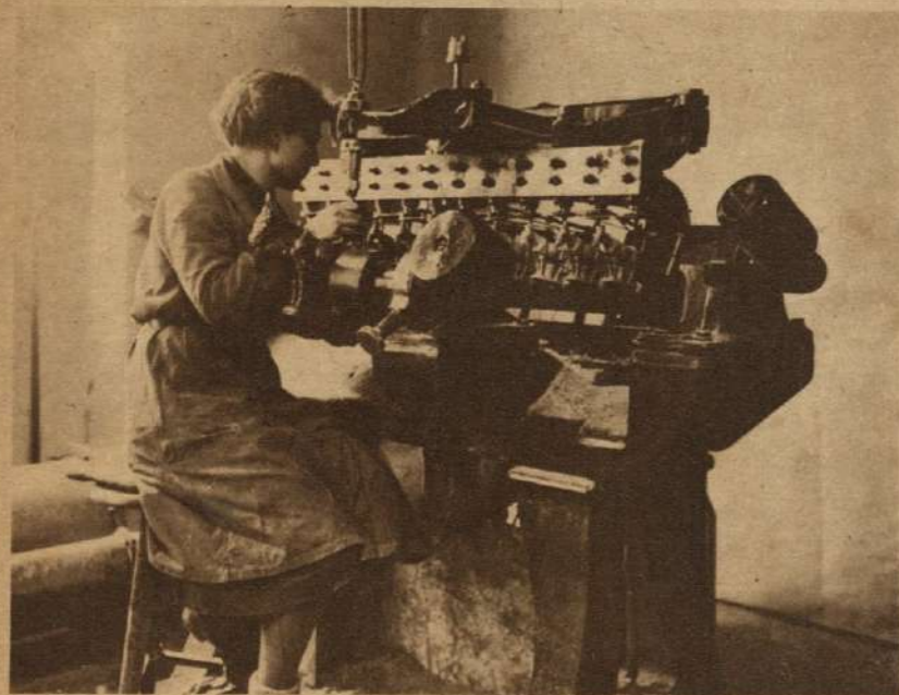
COMO SE LLEVA A CABO UN INGENUO FRAUDE. —La industria de la escultura de figuras de madera, supuestamente labradas a mano en Suiza, es en realidad un negocio mecánico, como puede verse por esta serie de fotografías publicadas por primera vez. He aquí el torno eléctrico que labra diez o veinte figuras de cada trozo de madera.
