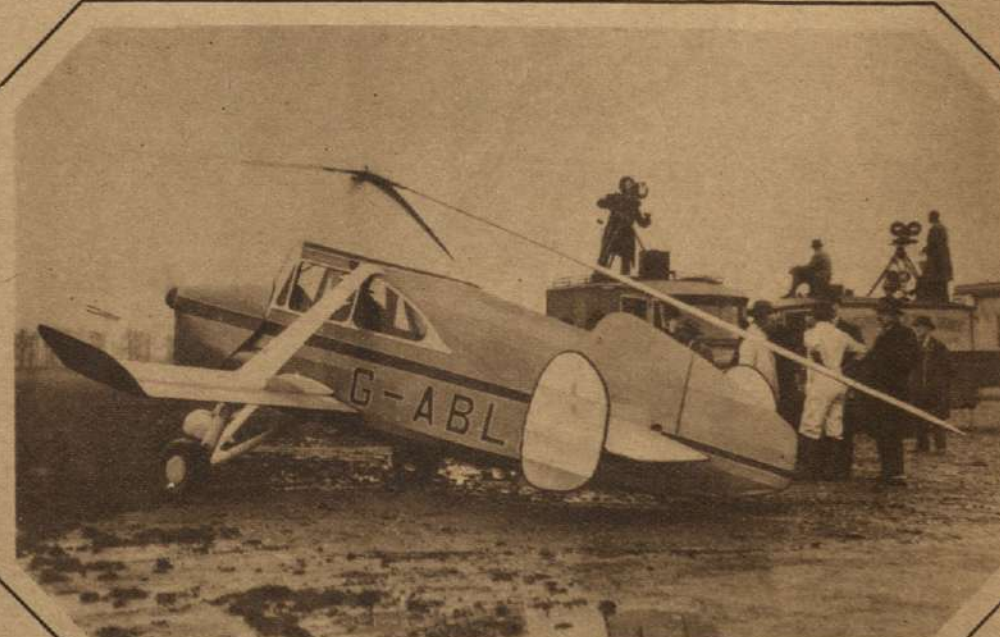
LOS PROGRESOS DEL AUTOGIRO. —En el aerodromo de Hanworth, Inglaterra, se efectuaron los primeros ensayos de este nuevo tipo de autogiro cerrado, para turismo de larga distancia. El aparato tiene solamente tres paletas revolventes en vez de cuatro.
