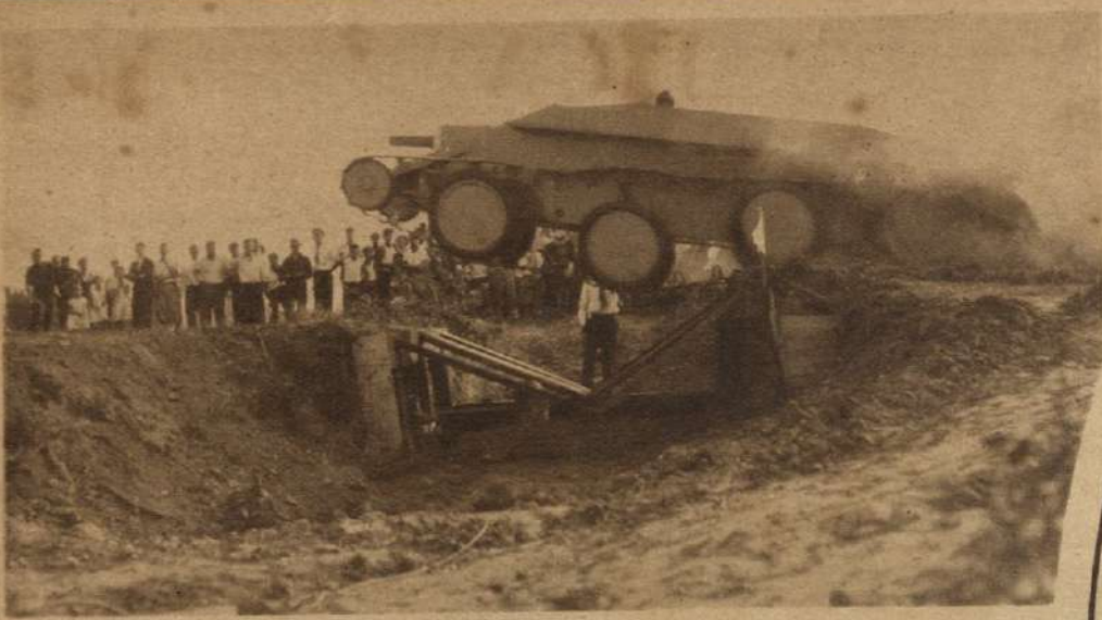
PARA LOS PACIFISTAS que creen llegado el momento del desarme universal, presentamos este tanque automóvil de doce metros de largo, que puede saltar zanjas a una velocidad de 150 kilómetros por hora. Lleva tres cañones, y aunque está blindado, puede transportarse por avión. Pertenece al ejército norteamericano
