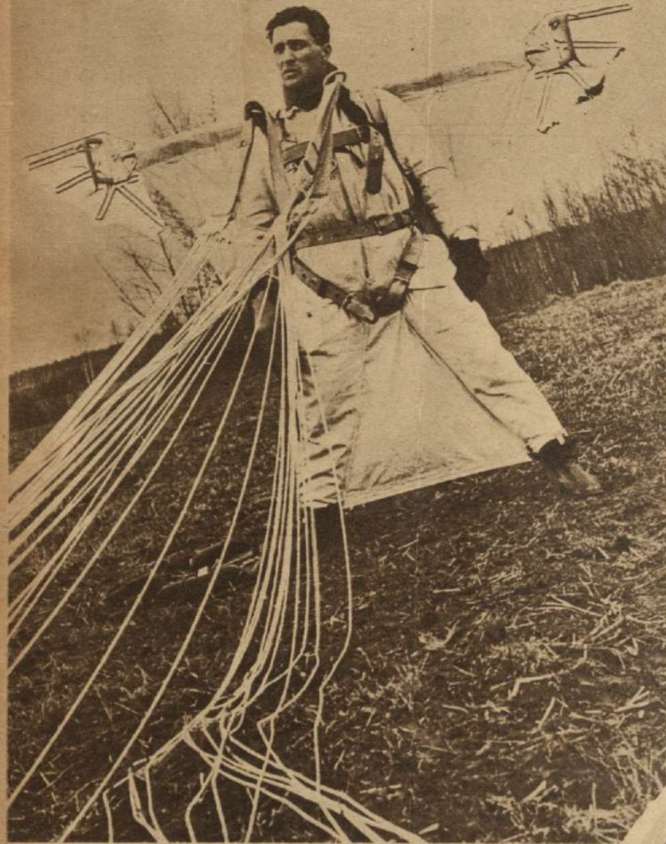
Un experimento arriesgado.—C. A. Schmidt de la aviación soviética, se dejó caer de un avión en pleno vuelo, usando un par de alas colocadas como lo indica la fotografía. Logró planear durante 900 metros en 45 segundos, luego, abrió su paracaídas, terminando el descenso sin contratiempo.
