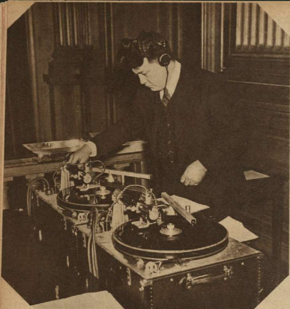
MAQUINA QUE ELIMINA A LOS ESTENOGRAFOS de los tribunales de justicia. Acaba de ser probada con éxito en Washington donde se vió que al acabar de grabar un disco, automáticamente comienza a grabar el otro.
