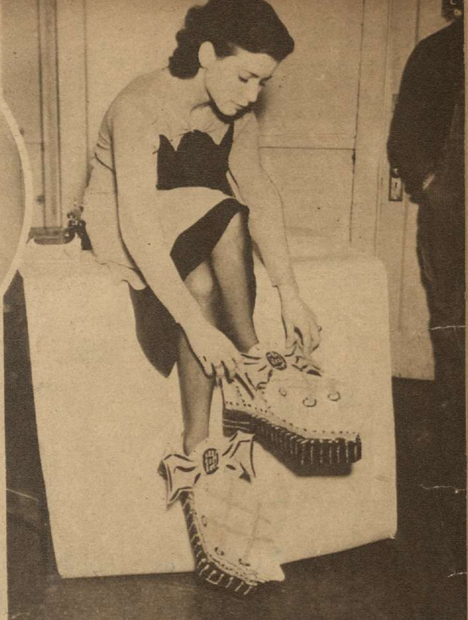
ESTE CURIOSO CALZADO, de madera y cemento, fué ideado por C. S. Harper, director de la Exposición de San Diego, en California para que su secretaria lo usara diariamente con el fin de analizar el desgaste de ciertos materiales empleados en el piso de su oficina.
