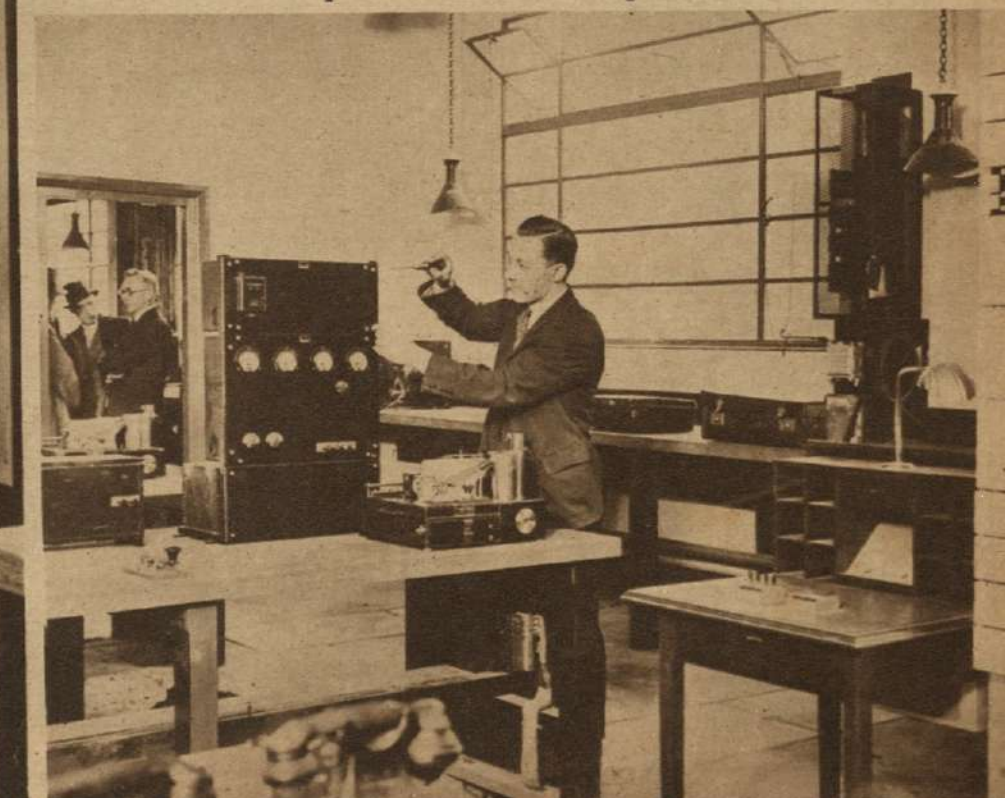
EL RADIO DESEMPEÑA UN GRAN PAPEL en la lucha de la policía contra los criminales y a eso se debe que la policía de Londres cuente con una estación magnífica. Aquí se ve el ajuste del ondulador que registra los mensajes en clave Morse.
