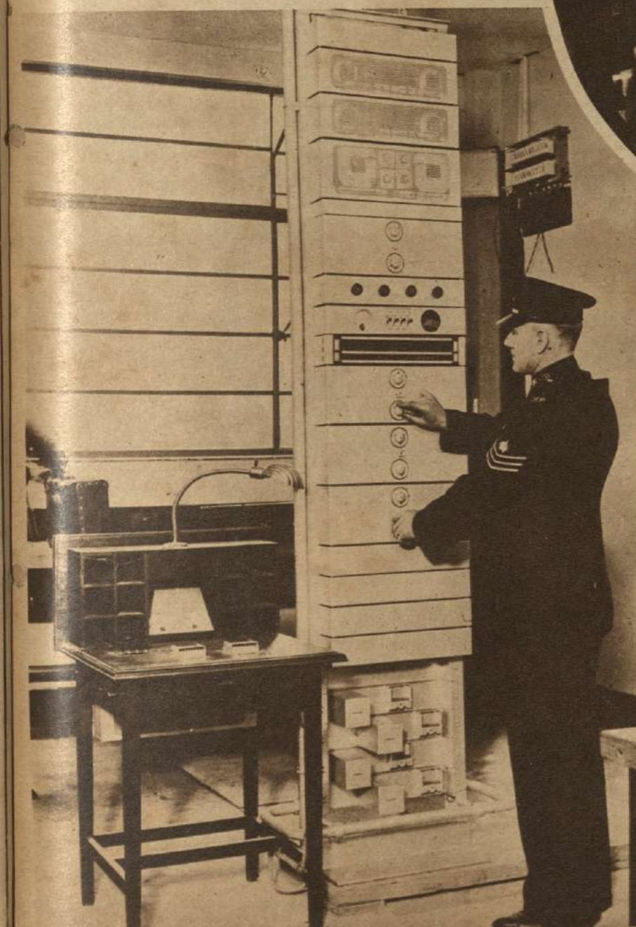
LA ESTACION DE SCOTLAND YARD , Londres, es la más completa instalación radiotelefónica con que cuenta una organización policial y "cubre" literalmente un radio de 40 a 50 millas desde el sitio donde se halla. Este es el panel de audio-frecuencia.
