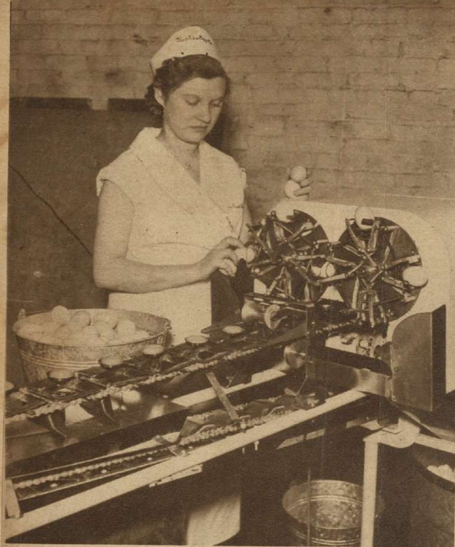
Esta ingeniosa máquina para abrir huevos, puede abrir 3600 huevos por hora. El contenido cae en un platillo mientras las cáscaras son expelidas lateralmente.
