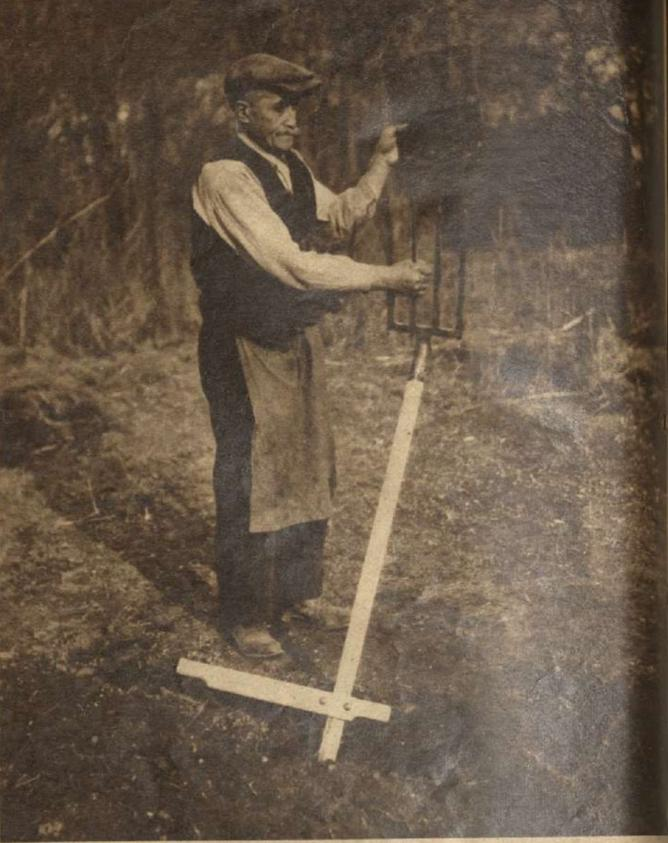
El conocido implemento hace el doble oficio de azada y de horquilla, mediante la adición de una placa metálica. Así, no hay que llevar al campo dos herramientas.
